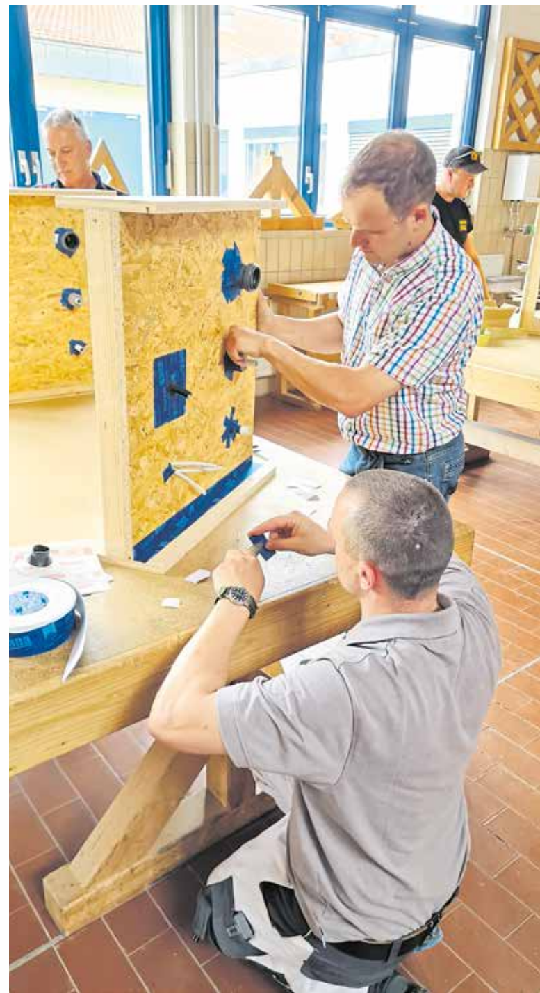
Für die Dichtprüfung werden Modelle angefertigt.
